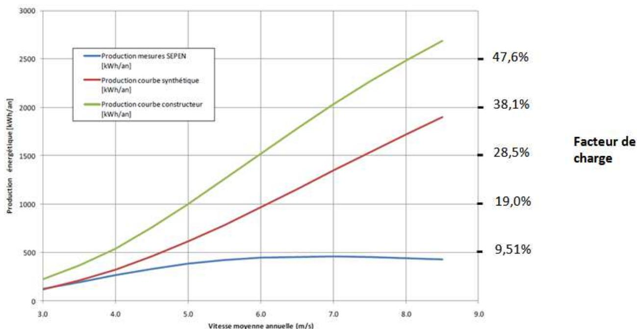
**Figure 2 : Productions énergétiques d'éoliennes : comparaison entre les données mesurées au SEPEN (disponibles sur <http://www.sepen-montplaisir.fr>) en fonctionnement nominal (courbe bleu), à régulation shuntée (courbe rouge) et les données constructeur (courbe verte) - machine BlackWind 0,6 kW.**
