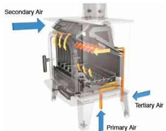
**Figure 14 : Poêle avec 3 entrées d'air**
