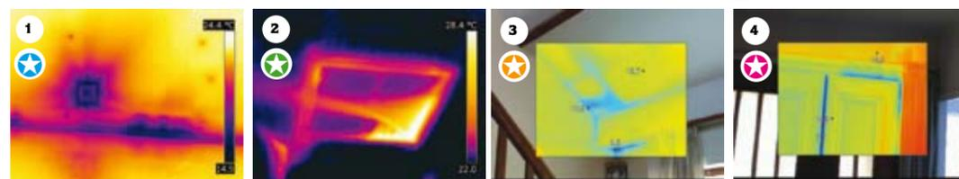
1. Jonctions de parois sol/mur + fuite dans le réseau électrique (© Air Vision) - 2. Trappe vers local non chauffé : rentrée d'air chaud de sous-toiture (© Air Vision) - 3. Jonctions de parois et toiture (© CO2 Conseil) - 4. Défaut d'étanchéité sur menuiserie et/ou autour (© CO2 Conseil)
