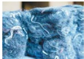
De haut en bas : botte de paille, briques de terre crue et isolant à base de textiles recyclés
