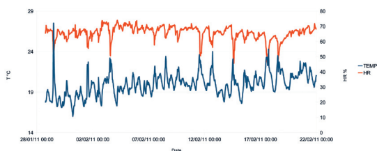
Mesures de température et d'humidité Evaluation de la température et de l'humidité du salon
