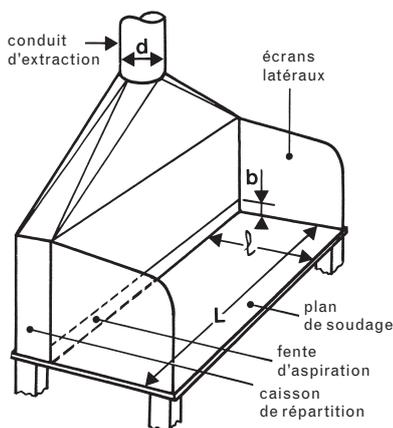
Figure 12. Table aspirante avec fente d'aspiration arrière.
