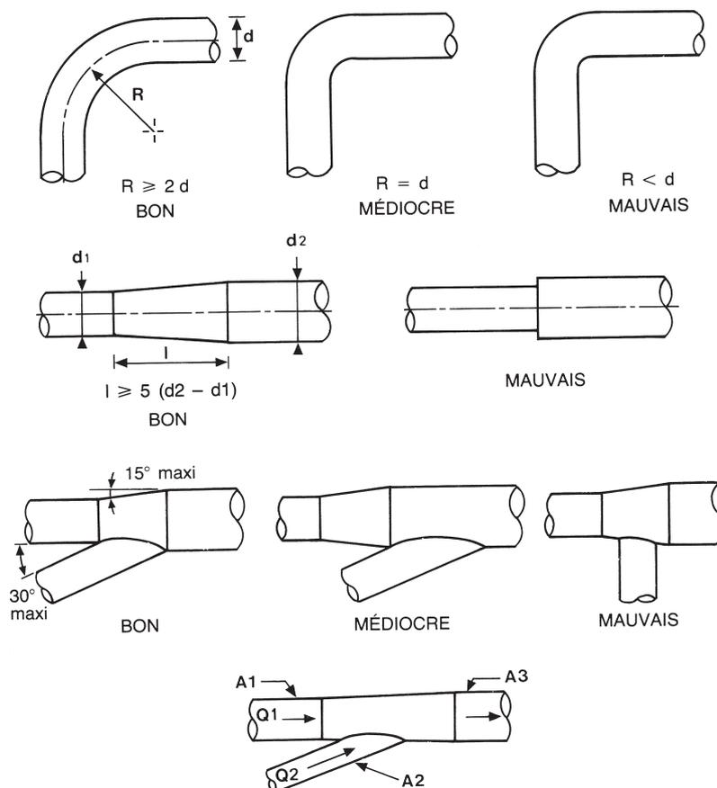
$$A3 = \frac{(Q1 + Q2)}{Vt}, \text{ avec } Vt : \text{ vitesse minimale de transport}$$
