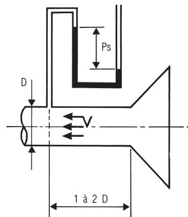
Figure 27. Implantation de la prise de pression statique à proximité d'un système de captage.
