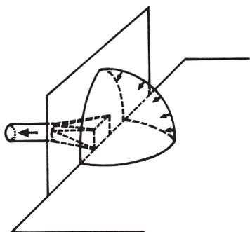
**Figure 10. Bouche d'aspiration avec large collerette reposant sur un plan. Pour des distances à la bouche assez grandes, les surfaces d'égale vitesse peuvent être assimilées à des quarts de sphère** (d'après Hemeon [3]).
