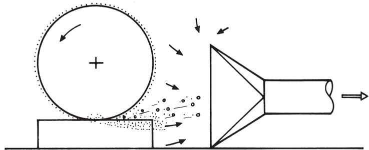
Exemple du meulage : un dispositif de captage placé sur le trajet des grosses particules peut capter la plus grande partie des poussières émises. Si celui-ci était disposé à l'opposé du jet des grosses particules, il ne pourrait pas capter les fines particules entraînées dans le sillage de ces dernières.
