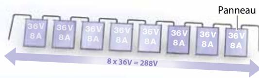
Fig. 4 : Exemple de chaîne photovoltaïque impliquant 8 modules.
