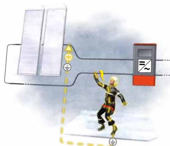
Fig. 20 : Contact direct et décharge capacitive
