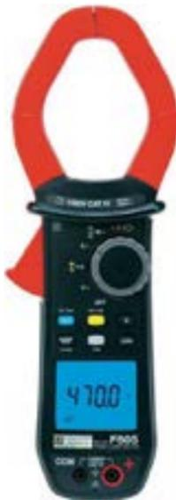
Pour effectuer une mesure de courant, différentes techniques et technologies existent, la plus simple étant l'utilisation de pinces de courant (ou capteurs de courant) car elles permettent d'effectuer une mesure sans couper l'alimentation, dans la mesure où l'élément conducteur (la ou les phases ou autre) est accessible.
