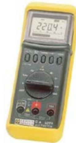
Le multimètre est l'outil que tout électricien se doit de posséder. Selon le modèle, on a accès aux mesures de tension, de courant, de résistance, de capacité, de fréquence, de rapport cyclique, de température, aux tests de diode, de continuité... On distingue plusieurs type de multimètres : le multimètre à mesure moyenne, le multimètre RMS, et le multimètre TRMS.
