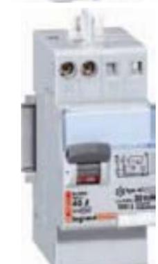
Exemple d'interrupteur différentiel bipolaire 40 A à haute sensibilité (30 mA) de type AC.
