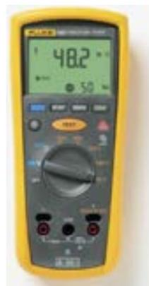
tion monophasée normalement alimenté en 230V AC, la tension continue à appliquer pour le test d'isolement est de 500V DC. La valeur de résistance d'isolement à trouver doit être supérieure à 500 kOhms.
