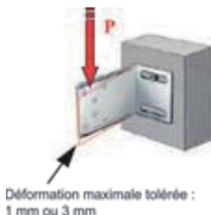
Les déformations maximales tolérées en fonction des types de bardages sont récapitulées dans le tableau suivant :
