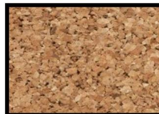
La particularité du matériau réside dans sa structure cellulaire avec une forte porosité (90 à 95 %) et une très faible densité du matériau brut.
