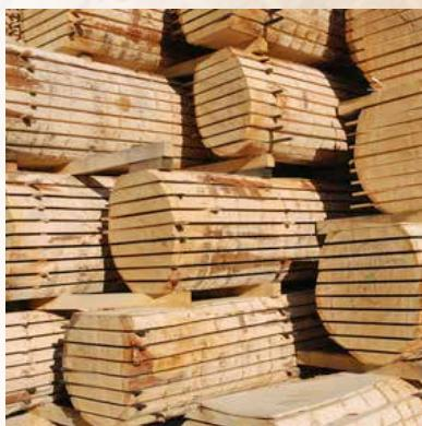
◁ Une fois les grumes de bois sciées, les planches sont entreposées pour le séchage. Des cales espacent chaque planche pour que l'air circule et que la planche reste bien droite et ne se déforme pas en séchant.
