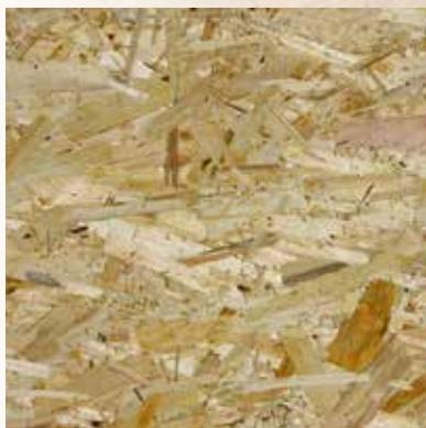
◁ Très couramment utilisés, les panneaux d'OSB (Oriented Strand Board, littéralement panneau de grandes particules orientées) étaient à l'origine produits à partir de résidus de placages et de contreplaqués. Ils contiennent 95% de copeaux de bois liés par 5% de résines chimiques. Les panneaux dits OSB3 sont réputés sans émanation de formaldéhyde.
