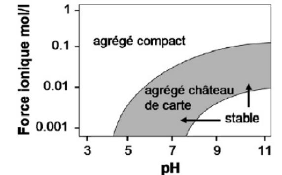
↑ Représentation schématique de la transition liquide-solide d'une suspension d'argile en fonction du pH et de la force ionique. La suspension peut être coagulée en décalant le pH de 10 à 5 ou en augmentant la force ionique à pH 10.
