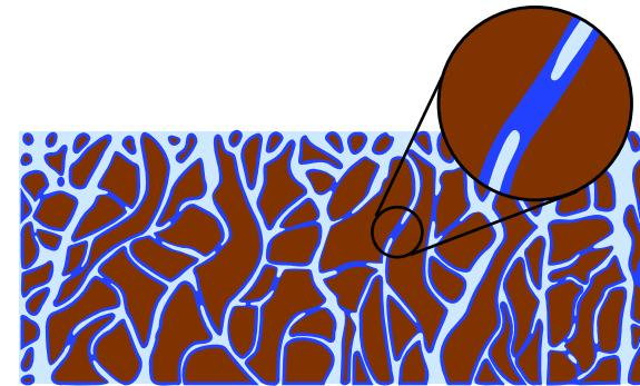
↑ Si les pores du matériau sont suffisamment fins, les couches d'eau adsorbées se touchent par endroit : il y a condensation capillaire.
