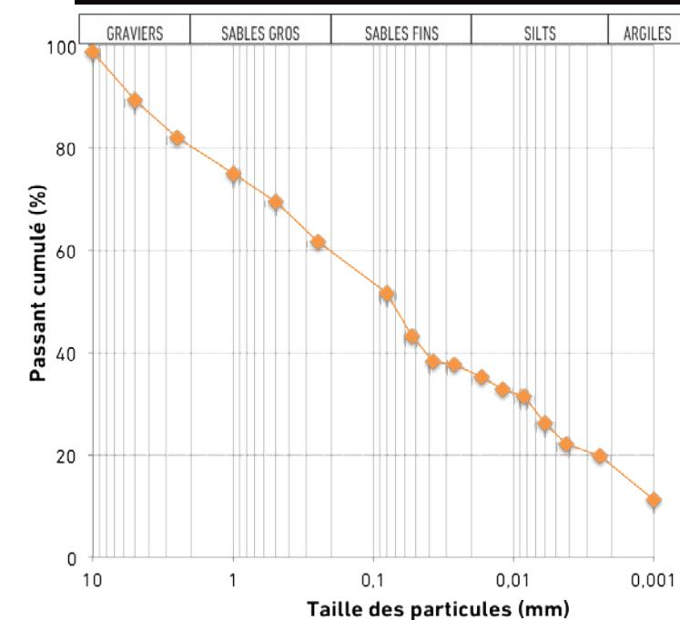
→ La courbe granulométrique de la terre de Brézins a été obtenue par tamisage pour les particules de plus de 0,08 mm, puis par sédimentométrie pour les particules plus fines. Cette courbe indique une proportion d'argiles (<0,002 mm) de 20 %. Le squelette est globalement équilibré avec la présence de toutes les tailles de grains en proportions équivalentes.
