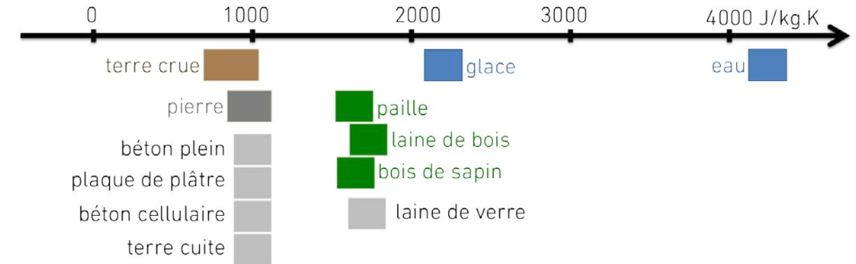
La capacité thermique massique ( $c$ ) indique la quantité de chaleur à fournir à 1 kg du matériau pour élever sa température de 1K. Cette propriété multipliée par la masse volumique détermine la capacité thermique volumique du matériau, en J/m<sup>3</sup>.K, qui est responsable de l'inertie thermique apportée par le matériau à une structure.
