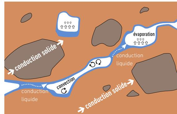
Définir la conductivité dans un matériau poreux hygroscopique comme la terre est complexe car plusieurs mécanismes de transfert interviennent dans trois phases différentes (terre, eau, air). La valeur de conductivité accessible par la mesure est une conductivité apparente, qui peut varier selon la technique expérimentale utilisée.
