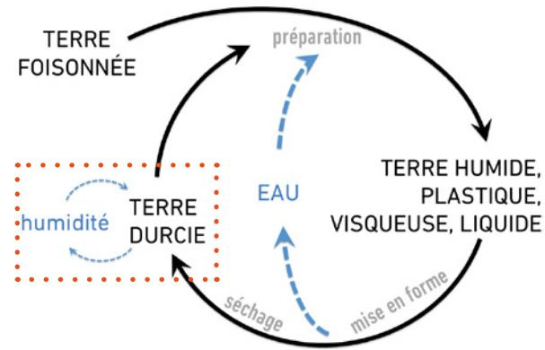
Après la phase de séchage, la terre atteint un état dans lequel sa masse reste à peu près constante. Le matériau est alors en équilibre avec le milieu ambiant et se charge plus ou moins d'eau en fonction de la température et de l'humidité de l'air.
