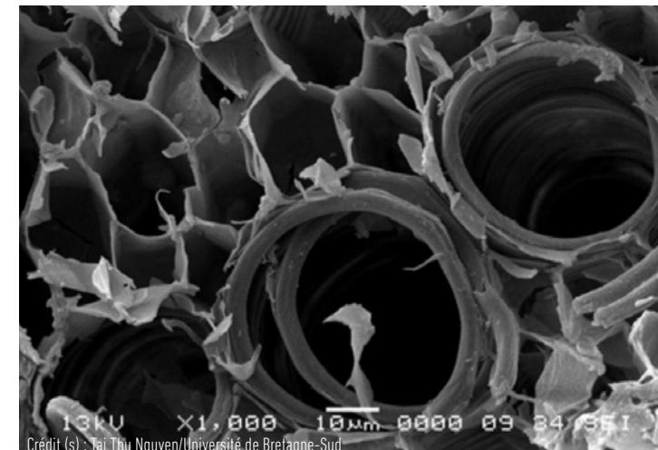
La microstructure de la chènevotte, faite de fins capillaires, permet un transport rapide d'eau liquide dans les particules. La chènevotte peut ainsi absorber jusqu'à 4 fois sa masse en eau. Cette absorption est beaucoup plus importante que celle des autres granulats légers utilisés dans la construction car la porosité est ouverte et fine.
