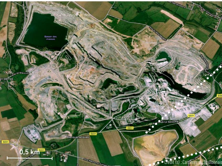
↔ Une carrière de granulats. Les boues de lavage des granulats sont récupérées et stockées en bordure de carrière. Elles forment d'impressionnantes collines de particules fines argilo-calcaires. Ce co-produit constitue une importante ressource minérale à valoriser.
