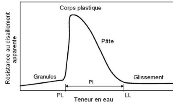
↑ La consistance d'une terre peut être caractérisée par sa résistance au cisaillement. Elle augmente très fortement lorsque la teneur en eau dépasse la limite plastique puis diminue si la quantité d'eau augmente.
