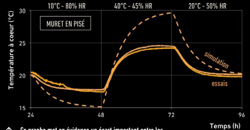
↑ Ce graphe met en évidence un écart important entre les mesures expérimentales de température au cœur du muret et la prévision obtenue par un modèle aux éléments finis.
