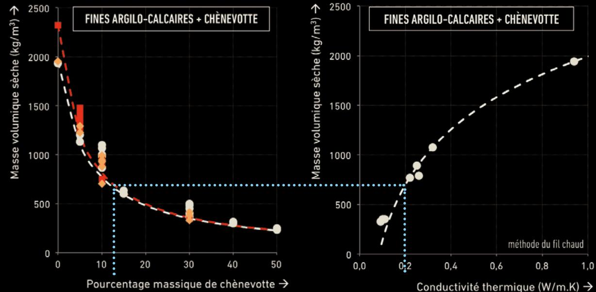
Le comportement mécanique des bétons de chanvre est déterminé en grande partie par deux paramètres : la qualité du liant argileux (importance du choix de la terre) et la masse volumique finale du matériau.
