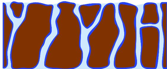
↑ Représentation schématisée du réseau poreux d'un matériau hygroscopique. Lorsque l'humidité ambiante est élevée, la surface des pores est recouverte d'une fine couche de molécules d'eau adsorbées.
