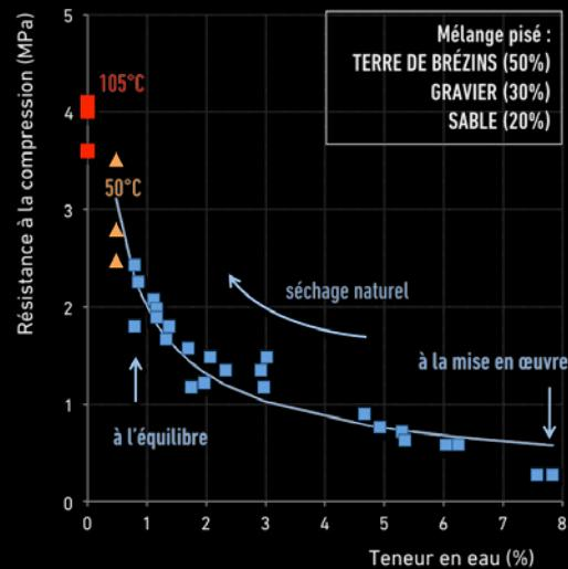
← Des cylindres de pisé ont été préparés avec une terre contenant 8% d'eau en masse. Des mesures de résistance à la compression ont été réalisées au cours du séchage. La teneur en eau des éprouvettes a été calculée à partir de pesées avant et après un séchage à 105°C.
