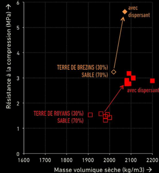
↑ Chaque point correspond à une éprouvette dont on a mesuré la masse volumique et la résistance à la compression. L'ajout d'un dispersant augmente la masse volumique et la résistance mécanique.
