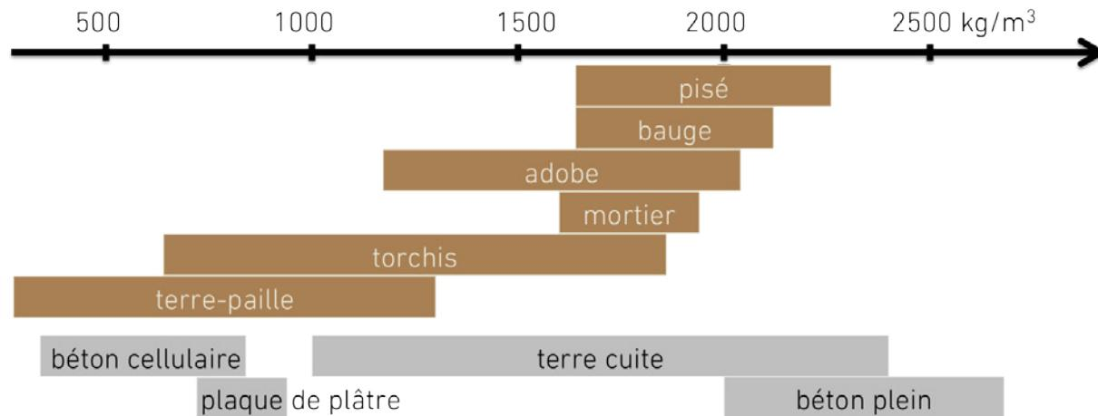
La masse volumique ou densité sèche ( $\rho$ ) d'une terre est le rapport entre sa masse et son volume mesurés à l'état sec après passage en étuve à 105°C. Cette propriété dépend de plusieurs paramètres dont les principaux sont la distribution granulométrique, la proportion et la nature de la phase liante, la teneur en eau à la mise en œuvre, et l'énergie de mise en œuvre (compaction, vibration, etc.).
