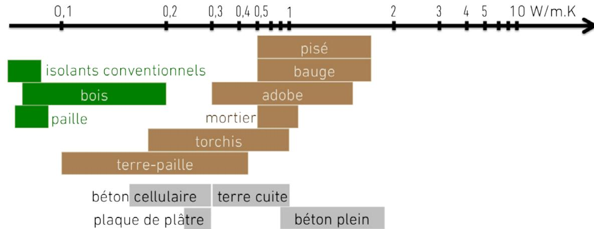
La conductivité thermique ( $\lambda$ ) indique la quantité de chaleur (en W) qui traverse par  $m^2$  de surface 1 mètre d'épaisseur de ce matériau pour 1 K d'écart de température entre la face extérieure et la face intérieure. Elle s'exprime en W/m.K. Plus  $\lambda$  est faible, plus le matériau est isolant. Sont considérés comme isolants les matériaux de conductivité inférieure à 0,065 W/m.K.
