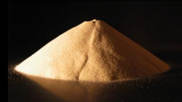
← En séchant, le pâte de sable mouillé redevient simple tas de sable impossible à mettre en forme. La cohésion apportée par les ponts capillaires s'est évaporée.
