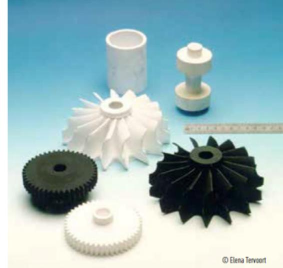
↑ La technique de Direct Coagulation Casting utilisée dans le domaine des céramiques techniques permet de durcir une barbotine liquide de manière différée dans le temps.
