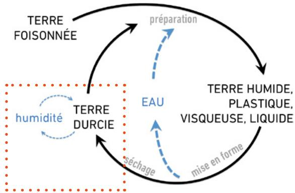
⚠ Une terre coulée dans des coffrages ne peut pas sécher et durcir. Le mur s'effondre au décoffrage.
