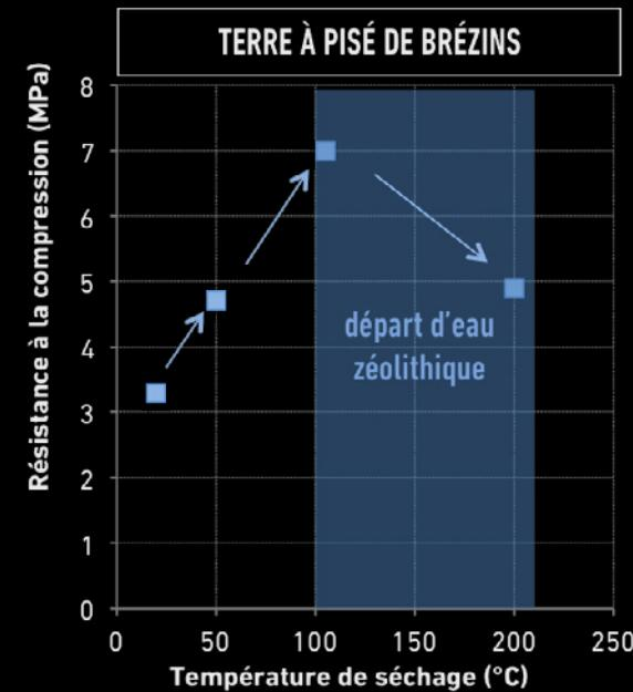
↙ Des éprouvettes de pisé réalisées avec la terre de Brézins ont été séchées à différentes températures puis caractérisées en compression. La résistance passe de 3,3 MPa à 7 MPa après un séchage à 105°C, puis elle diminue suite au départ de l'eau qui assure une cohésion capillaire entre les feuillets d'argile.
