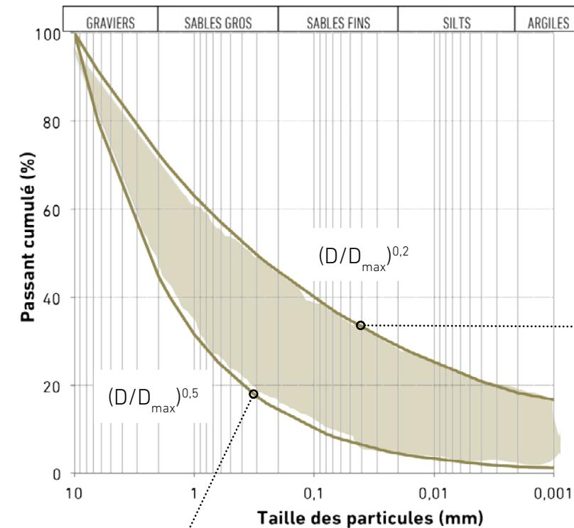
← La répartition des tailles de grains au sein d'un matériau granulaire peut se représenter sous la forme de courbes granulométriques. Les empilements les plus compacts se situent dans le faisceau coloré. Ce faisceau est délimité par deux courbes qui rapprochent d'empilements théoriques différents.
