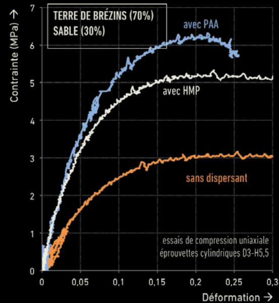
↑ Les courbes de comportement en compression uniaxiale ont été mesurées pour des éprouvettes de terre tamisée à 0,1 mm mélangée à du sable, avec et sans dispersant (HMP : hexamétaphosphate de sodium, PAA : acide polyacrylique).
