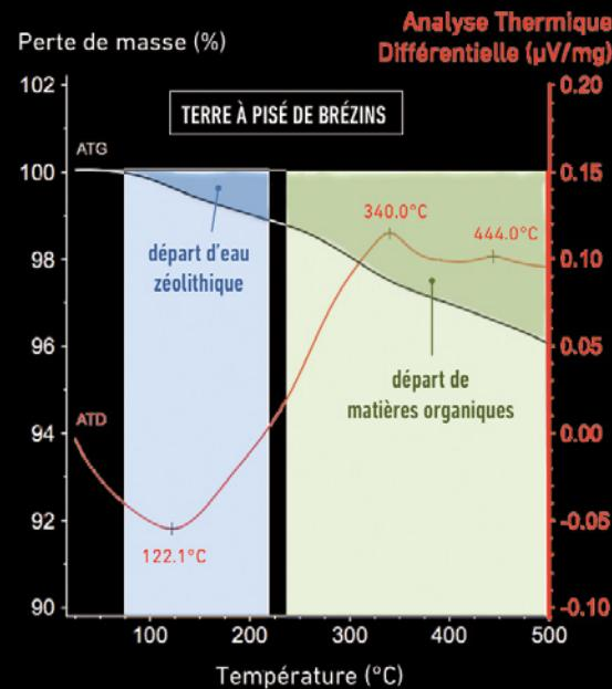
← L'analyse thermique différentielle effectuée en laboratoire permet de mesurer d'une part la perte de masse d'un matériau au fur et à mesure qu'on le chauffe, et d'autre part la quantité d'énergie qu'il libère ou qu'il absorbe par rapport à un échantillon témoin qui ne subit aucune réaction ni changement de phase dans la gamme de température explorée.
