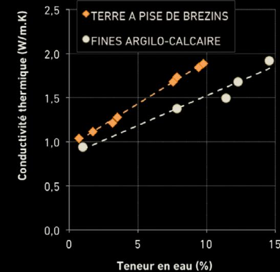
← La conductivité thermique d'une terre dépend de sa teneur en eau. C'est ce que montrent ces mesures réalisées sur la terre de Brézins et les fines argilo-calcaires avec la technique du fil chaud.
