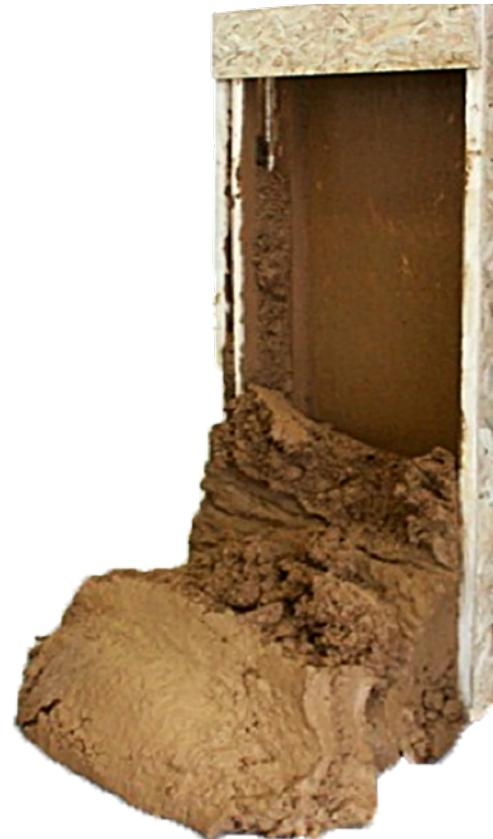
Une fois mise en œuvre avec la quantité d'eau adéquate, la terre doit sécher pour durcir. Pendant cette phase, des quantités importantes d'eau doivent pouvoir s'évaporer. Par exemple, un mur de 1 m<sup>2</sup> en bauge façonné à l'état plastique doit perdre environ 150 kg d'eau pour atteindre son état d'équilibre !
