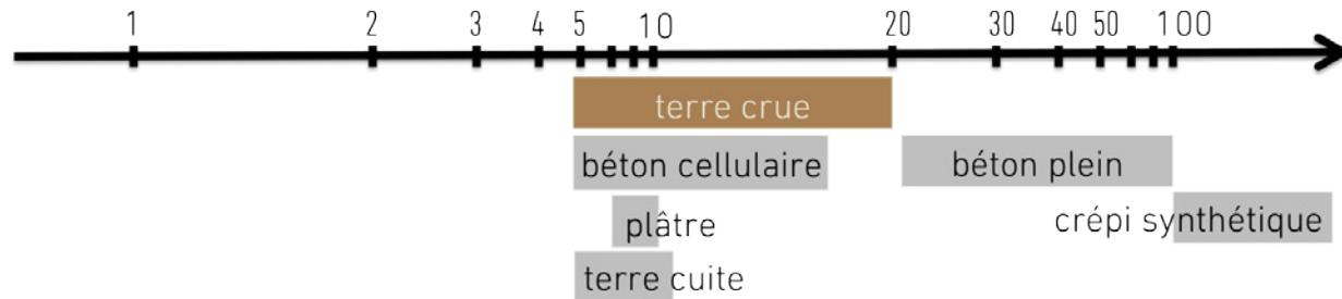
La capacité d'un matériau à résister à la diffusion de la vapeur d'eau est représentée par le facteur  $\mu$  qui est le rapport entre la perméabilité de l'air à la vapeur d'eau et celle du matériau considéré. Plus ce coefficient est faible, plus le matériau est perméable à la vapeur.
