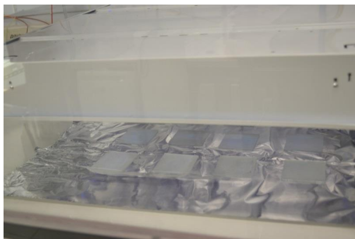
Figure 132 : Positionnement des plaques recouvertes du matériau ARMINES dans une enceinte de 1,17 m 3
