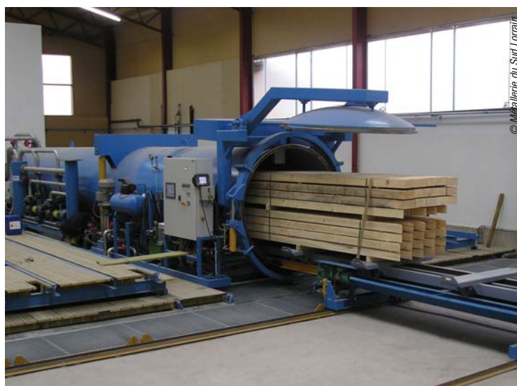
Traitement d'une charpente par autoclave.
