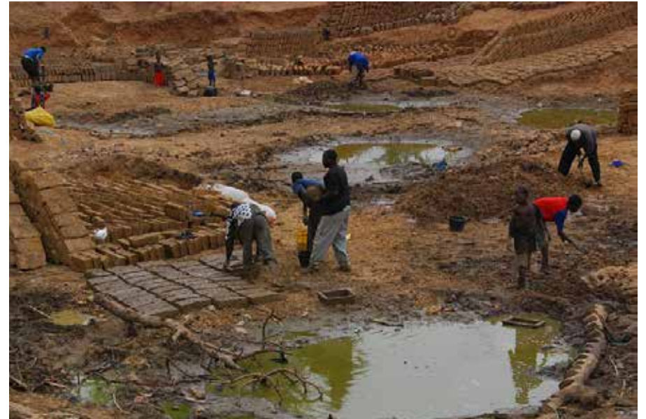
Fabrication de briques de banco au Mali
