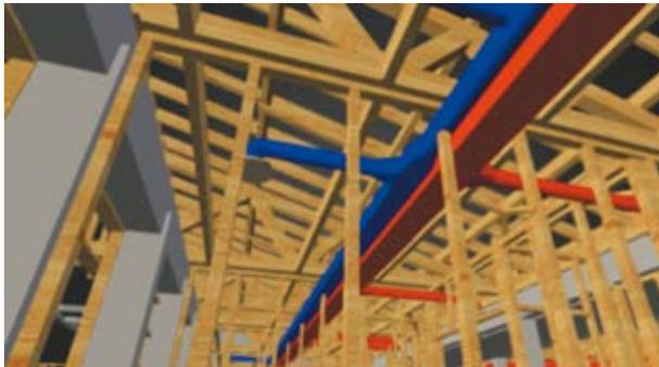
Cas de collision des réseaux fluides avec la structure. ©AQC-2015
