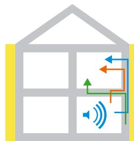
**Attention !** En présence d'un isolant thermique et acoustique intérieur (matériau souple), le fait de supprimer cet isolant et de lui substituer un isolant extérieur (ITE) peut se traduire par une augmentation de la transmission des bruits entre locaux contigus (préjudiciable en maison en bande ou en immeuble collectif).
