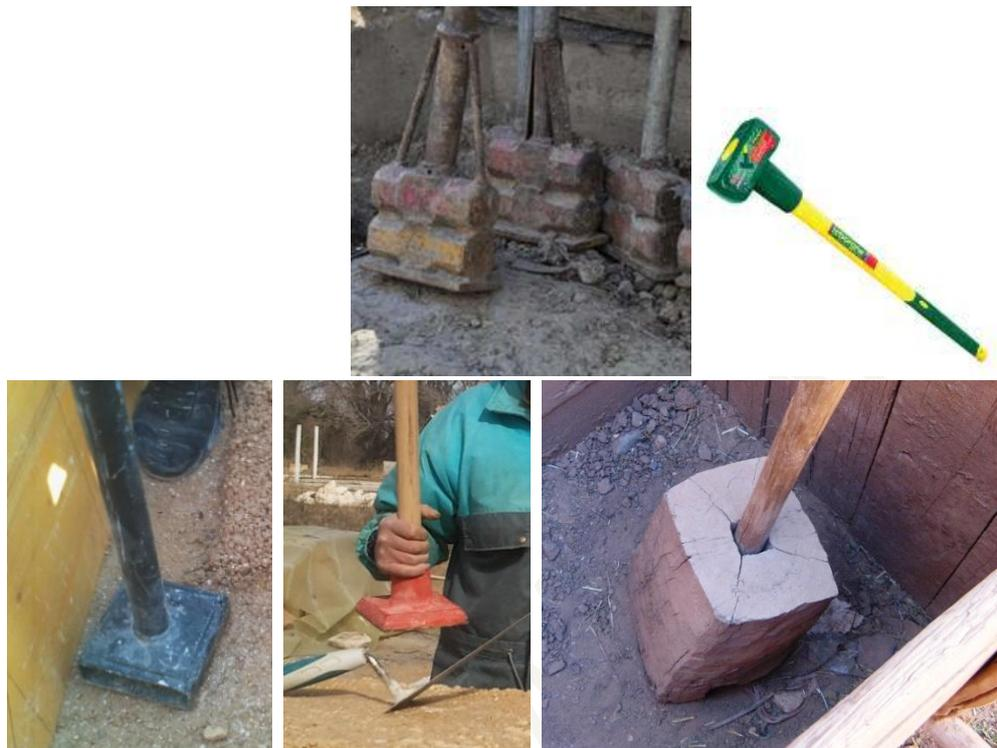
Plus la tête du piseoir est petite, plus l'empreinte dans la terre est petite, et plus la pression d'impact est importante. Pour rester maniable, le poids d'un piseoir manuel est environ égal à la surface de sa **base (A mesurer sur nos piseoirs)**
