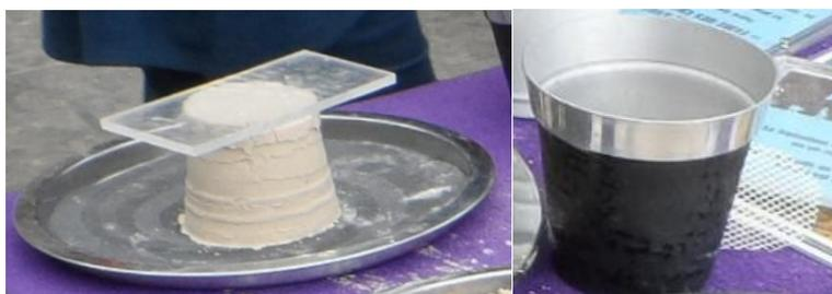
Le grillage géotextile (trame en fibre de verre recouverte de polyamide) est bien adapté au renforcement des constructions en pisé. Les trames végétales (jute, chanvre, ...) ne sont pas assez résistantes pour reprendre les tensions internes du mur. Le grillage n'est pas posé entre deux lits de terre, mais au sein des lits de terre, à peu près au 2/3 de la hauteur d'un lit. Il n'y a pas de compactage intermédiaire au niveau du grillage.
