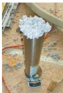
Échantillon de vérification de la densité. ©AQC-2015
