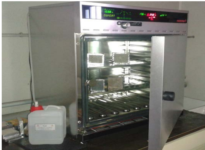
Figure III. 7: . Chambre climatique contrôlée en température et en humidité relative
