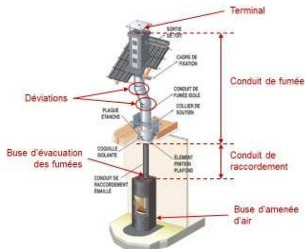
Figure 19 : représentation schématique d'un conduit d'évacuation des produits de combustion et de ses différentes parties (adapté d'un schéma de la société Poujoulat).
