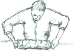
*Illustration 30: **Pose enroulée** :Préfabrication d'andouilles, fuseaux, fusées ou quenouilles constitués de palançons ou barreaux enrobés de torchis sous forme de nappes ou de torches enroulées en spirales, souvent sur table.*
